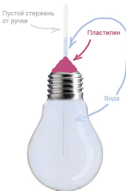
Рисунок 4. Устройство нашей модели жидкостного термометра
