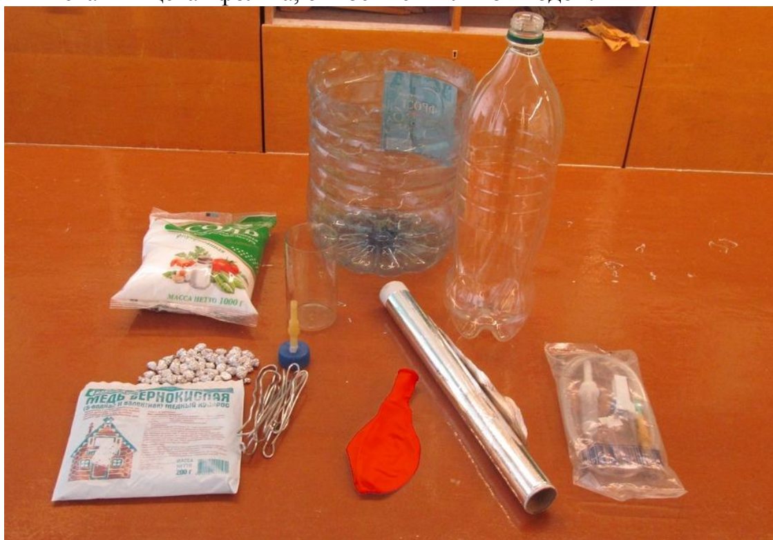
Рисунок 1. Оборудование для добычи водорода химическим способом
