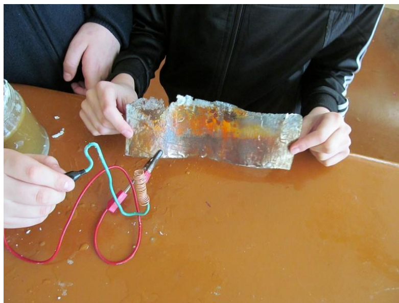
Рисунок 4. Коррозия алюминиевого электрода после проведения эксперимента
