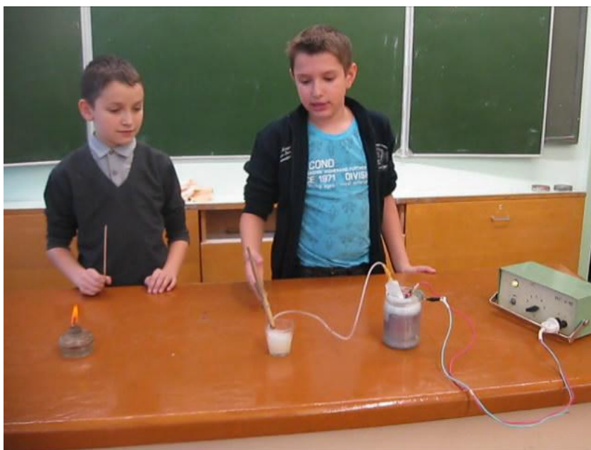
Рисунок 3. Установка по добычи водорода электролизом
