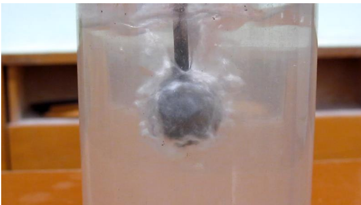
Рисунок 3.2 Неустойчивая паровая пленка вокруг шара. Переход к пузырьковому кипению
