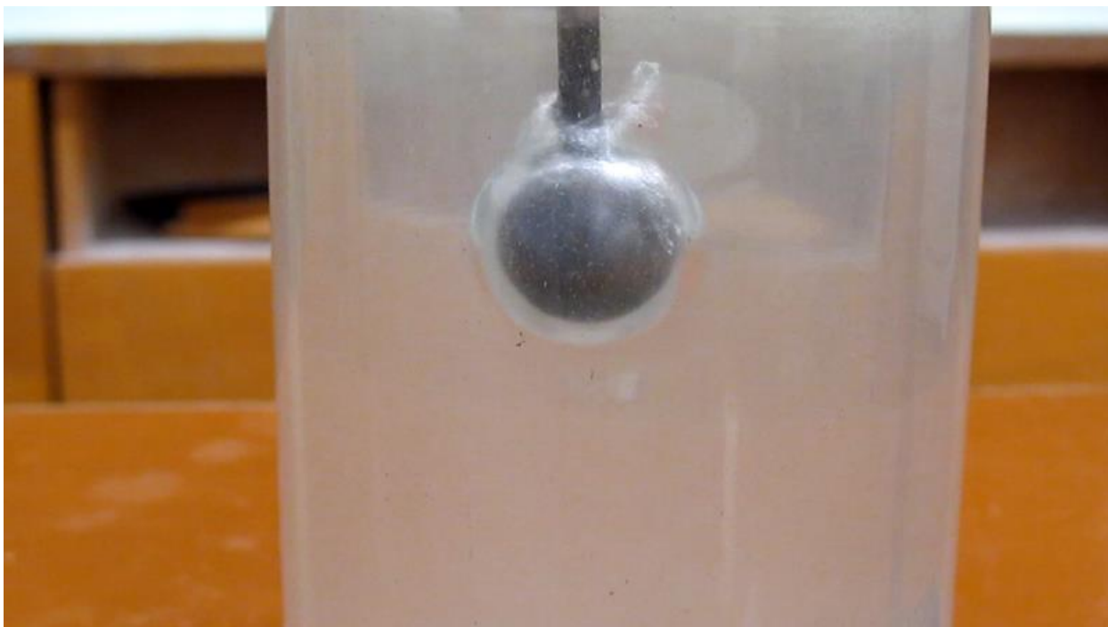
Рисунок 3.1 Устойчивая паровая пленка вокруг шара
